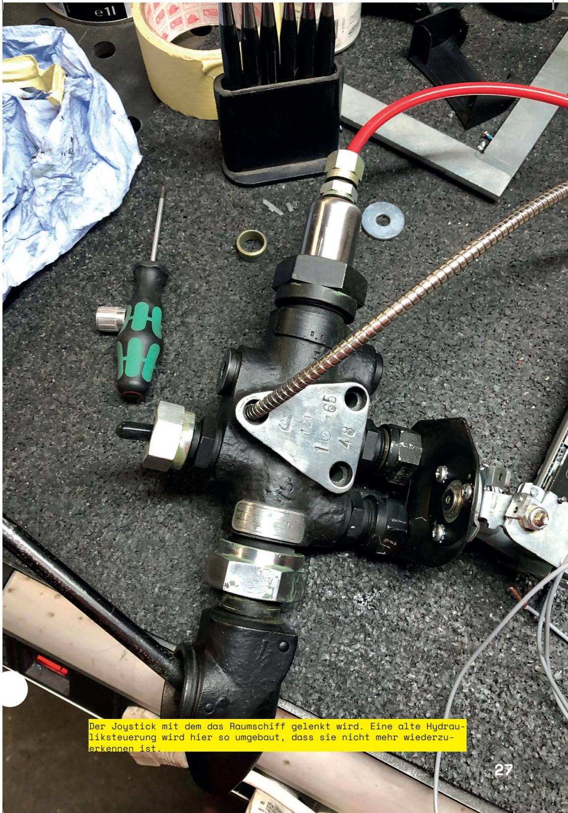
Der Joystick mit dem das Raumschiff gelenkt wird. Eine alte Hydrauliksteuerung wird hier so umgebaut, dass sie nicht mehr wiederzuerkennen ist.
